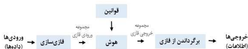
شکل (۱). ساختار کلی سیستم فازی
